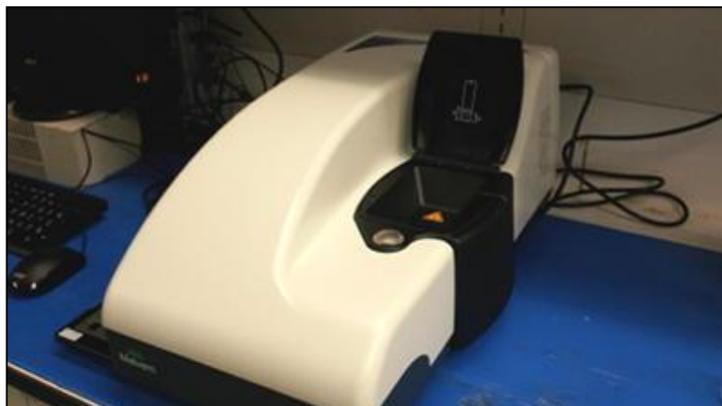
Analyseur Taille de Particules (DLS), Malvern, Zetasizer Nano S90
